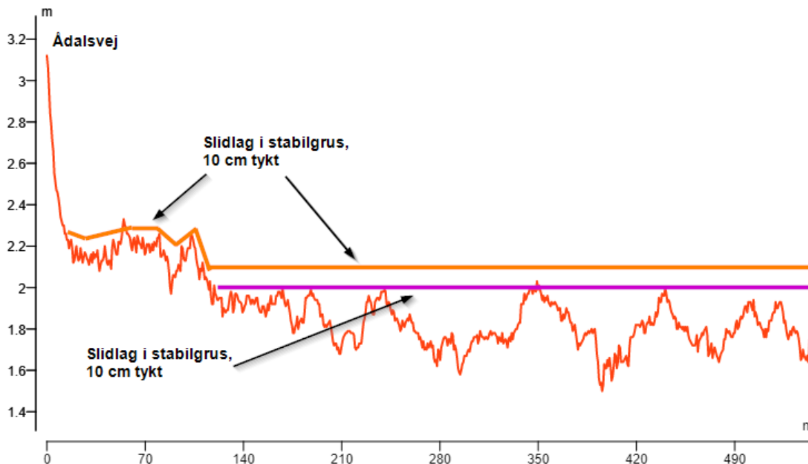
Figur 3-26 Længdeprofil af markvejen, som hæves.
