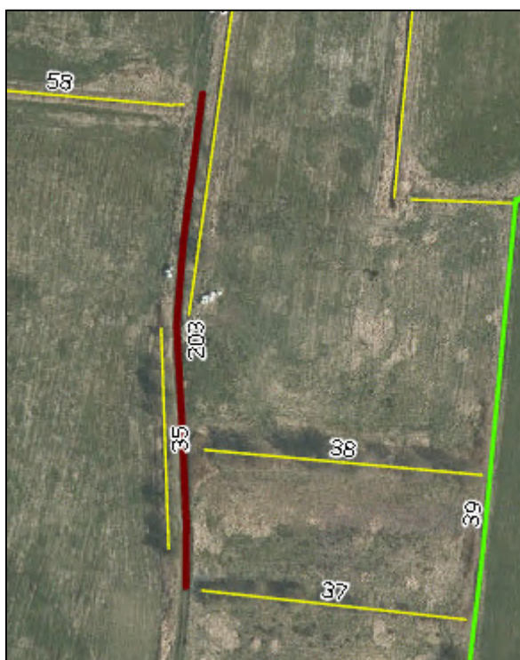
Figur 3-23. Strækning af hævet markvej fra grøft nr. 37 til 58. Der udlægges stabilgrus på hele vejens strækning (160 m).
