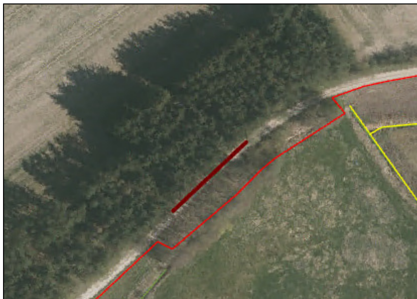
Figur 3-19. Strækning af Rævebrovej, hvor vejbanen ligger lavt i terræn og derfor planlægges hævet.
